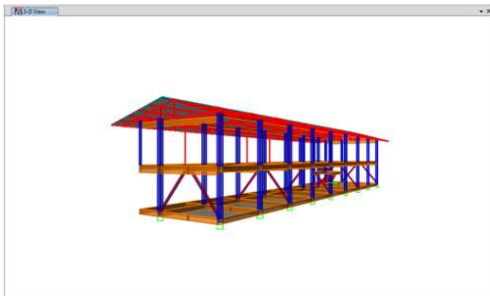
รูปที่ 4.48 ตำแหน่งเสริมกำลัง แบบ Inverted V (ต่อ)
