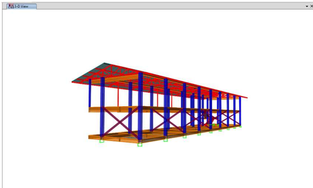
รูปที่ 4.37 ตำแหน่งเสริมกำลัง แบบ Braced (ต่อ)
