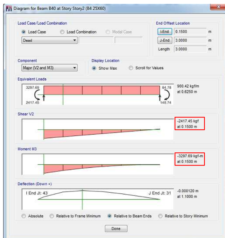
รูปที่ 4.52 แผนภูมิแรงเฉือนและ โมเมนต์ดัดในคาน จากน้ำหนักบรรทุกคงที่ (Dead Load) แบบ Inverted V
