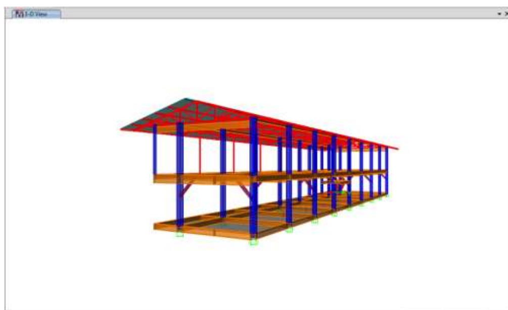
รูปที่ 4.60 ตำแหน่งเสริมกำลัง แบบ Knee Braced (ต่อ)
